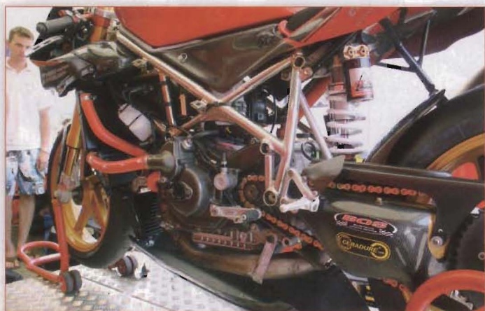
• Veramente bellissima questa supermono, che nasce dalla ciclistica di una 748R con forcella Öhlins, ammortizzatore WP e carenatura completa in carbonio.
